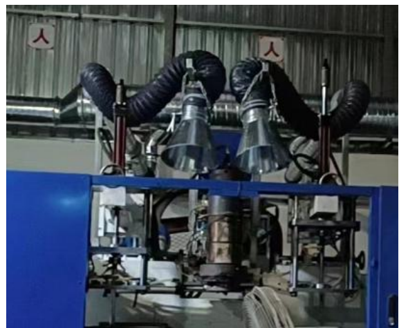
图 2 集气罩收集废气
