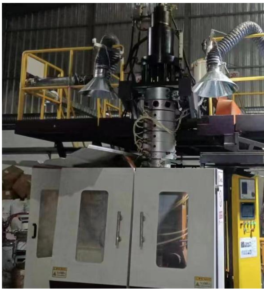
图 1 集气罩收集废气
